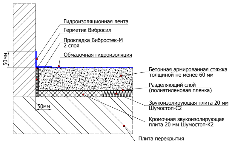
6.8.3 Схема устройства гидроизоляции в конструкции плавающего пола с применением звукоизолирующих плит Шумостоп в один слой
