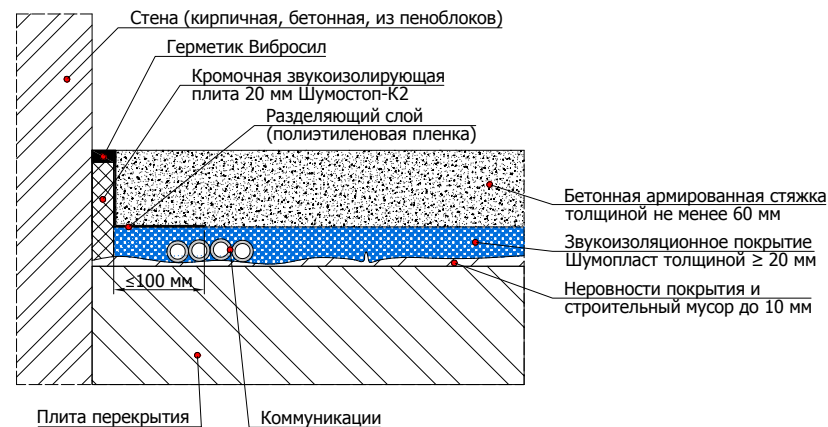
6.5.4 Схема устройства конструкции плавающего пола с коммуникациями под стяжкой с применением звукоизолирующего покрытия Шумопласт
