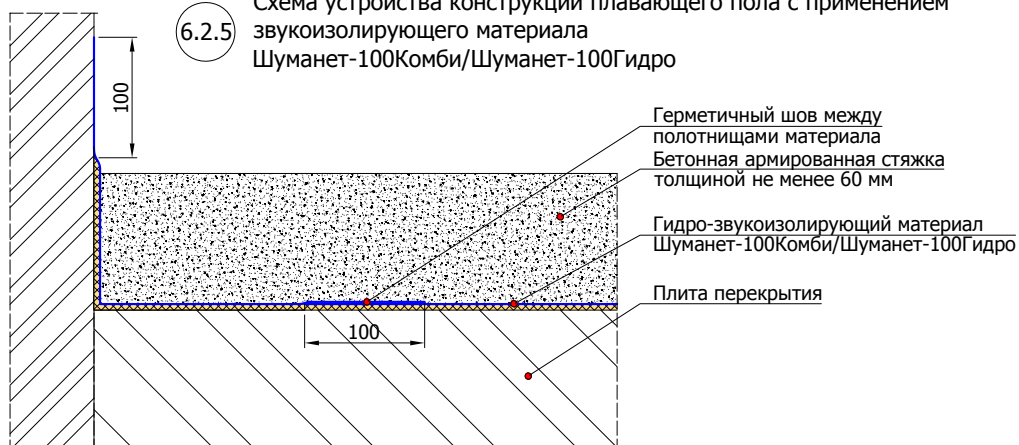
6.2.7 Схема устройства конструкции плавающего пола с применением звукоизолирующего материала Шуманет-100Комби/Шуманет-100Гидро в санузле
